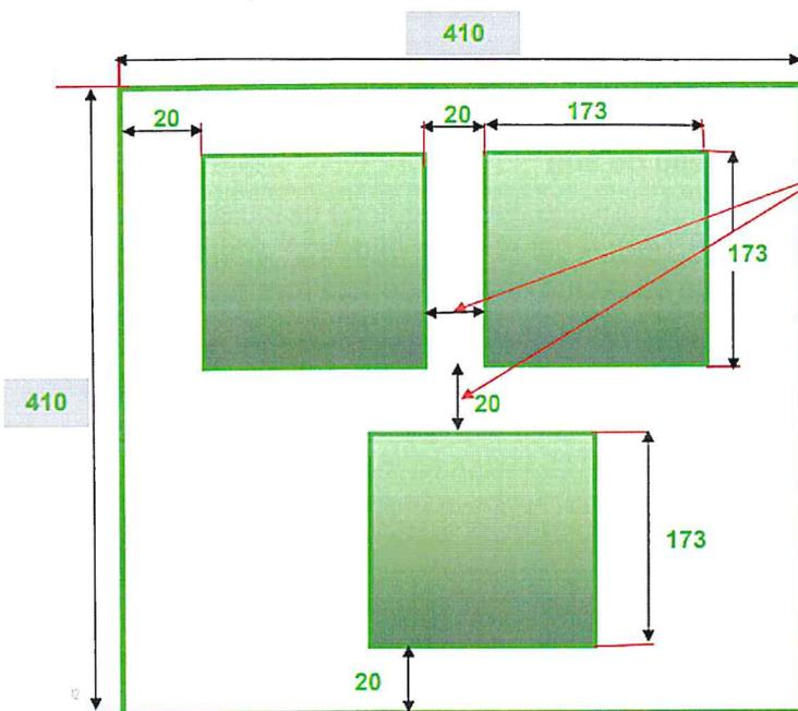
⚠ Pour les conteneurs avec ailes béton, bien prendre en compte les dimensions des ailes : 2\*12cm
