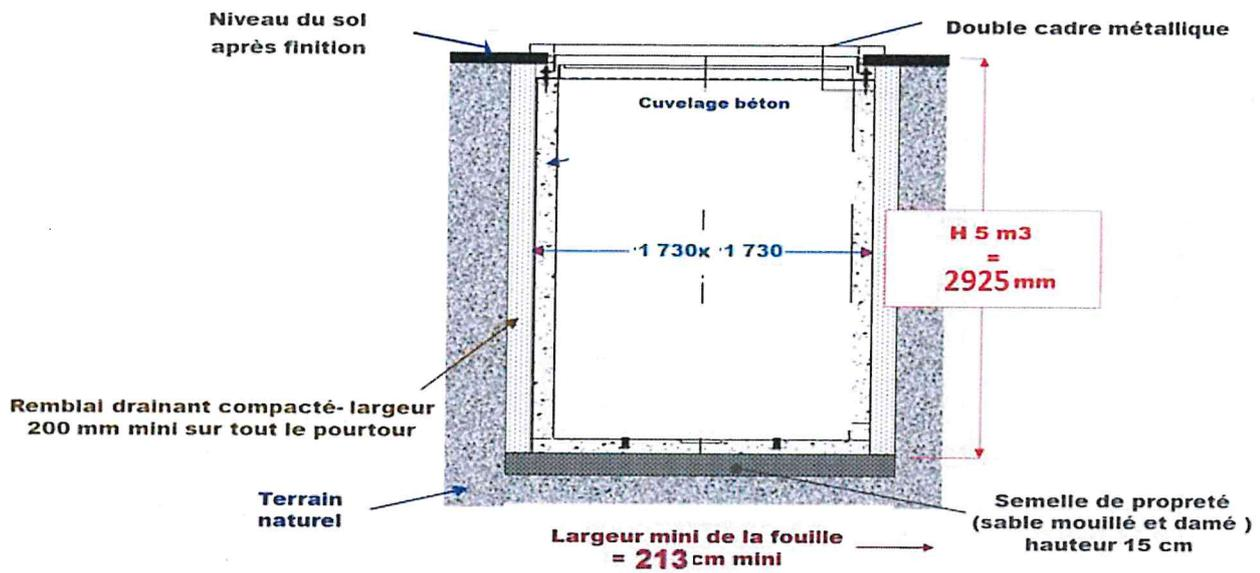
*Le conteneur se trouvera 1 cm au-dessus du niveau 0, permettant ainsi une finition en léger dénivelé, facilitant l'écoulement des eaux.*
