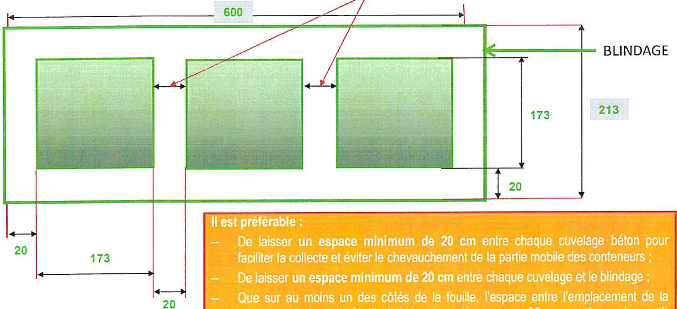
⚠ Pour les conteneurs avec ailes béton, bien prendre en compte les dimensions des ailes : 2\*12cm
